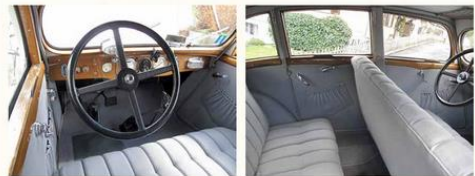
••• Čtyřmístná limuzína Wikov 40 Standard měla velmi pohodlnou sedadla zabudovaná kvalitní látkou. Přístrojová deska obsahovala tachometr s denním počítadlem, omezení hodiny (včetně nastavení Jager), dakometr oleje a další obyčejné přístroje. Jízdní byl doplněn i na zážehnou výřezku ze Wikov Standard měl však na rozdíl od kolony přístrojového vozu v základě vybavení se pouze jedním středním (předním) řádkem samostatně a nebyl vlny dodáván a bláznivá. (Foto Jitka Pollak)
