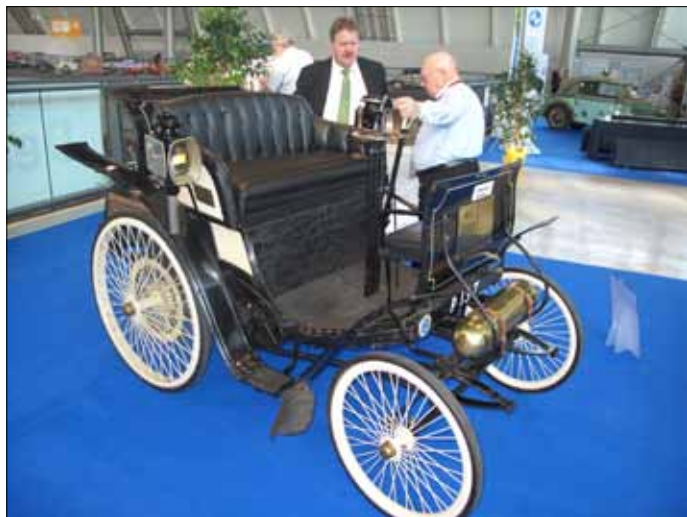
Druhý majitel tohoto Benz Velo Comfortable z roku 1898 vysvětluje návštěvníkovi funkční zvláštnosti původního motoru, který dodával 2,75 hp a jezdil rychlostí až 25 km/h
