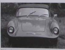
Příd rodstevu se světlomety zapuštěnými do sblých předních blatníků
