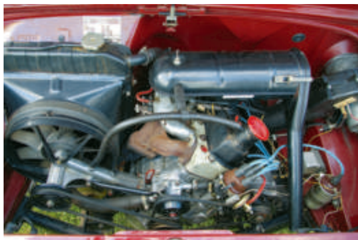
Der komplett neu aufgebaute Vierzylinder-Heckmotor wurde mit größeren Laufbuchsen auf 1,2 Liter Hubraum gebracht.
