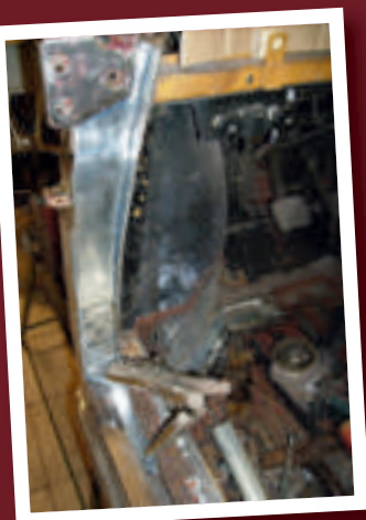
An der A-Säule wurden Stege aufgeschweißt, um die Spaltmaße der Tür zu korrigieren.
