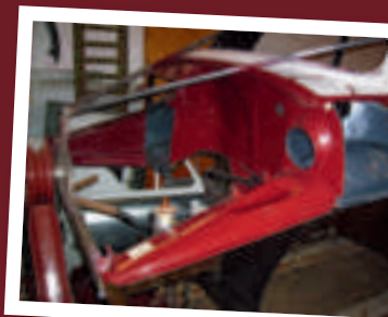
Die Karosserie war in einem drehbaren Gestell fixiert. So konnte Brathe bequem an allen Stellen arbeiten.
