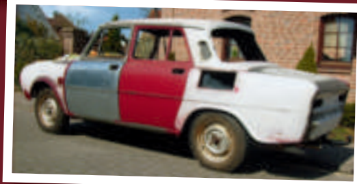
Der zusammengebaute Viertürer ist fertig für die finalen Lackierarbeiten.
