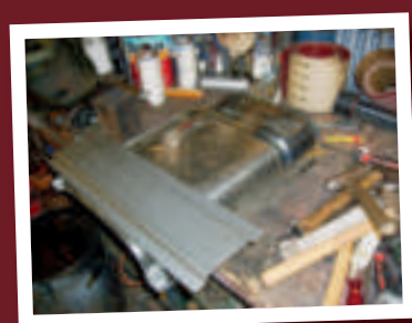
Viele Karosseriebleche musste Dieter Brathe auf extra angefertigten Schablonen selbst herstellen.
