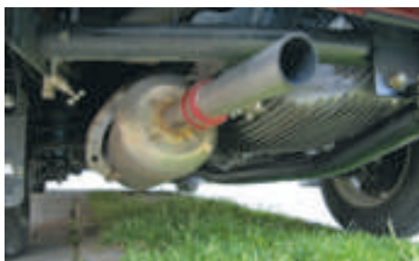
Handarbeit: Der Edelstahlauspuff entstand aus einem Feuerlöschbehälter.
