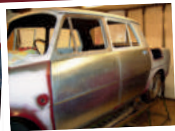
Die linke Türhaut fertigte Dieter Brathe selbst aus einer Blechtafel an.
