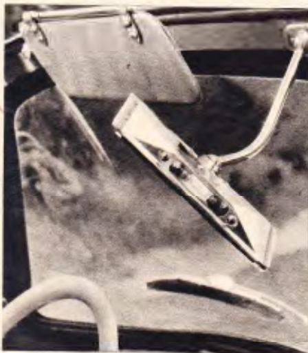
Eine raffinierte Lösung ist die im Spiegel eingebaute Innenbeleuchtung. – Die großen Fensterflächen im Heck des aufgesetzten Verdecks bieten nach allen Seiten eine gute Sicht. Die kleinen Heckflössen gestatten
