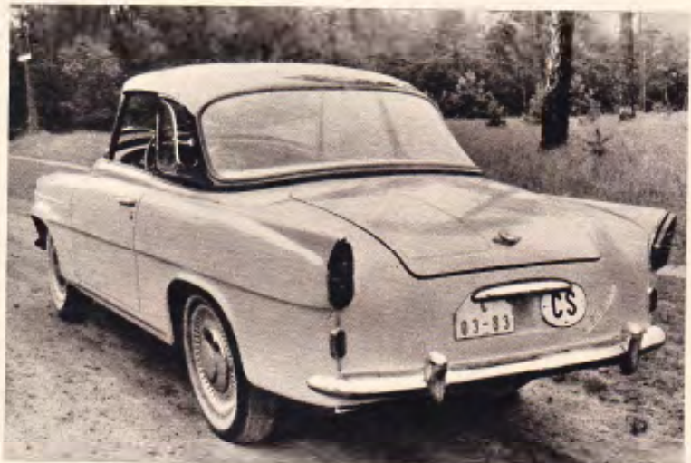
das Visieren beim Rückwärtsfahren und ermöglichen den Anbau dieser gegenüber früheren Typen wesentlich größeren Heckleuchten. Die Kofferklappe war verbogen worden, daher der große Spalt.
