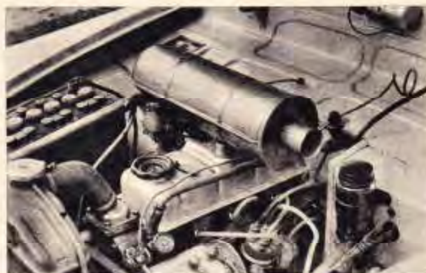
Die Maschine vom Oktavia Super ist über einen weiten Drehzahlbereich elastisch und sehr sparsam im Verbrauch. Im Vordergrund über der Lichtmaschine ist der Heizwasserhahn zu sehen. Wird er abgesperrt, so strömt über die Heizung wahlweise kühlende Frischluft in den Fußraum.
