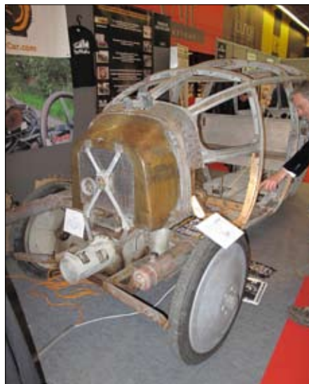
Aerodynamický pojízdný skelet Jacquese Gérina, 1921 – dva roky testovaný a nikdy karosovaný, motor před zadní osou, 2L, 4 válce, 8 svíček – bezestupňová převodovka
