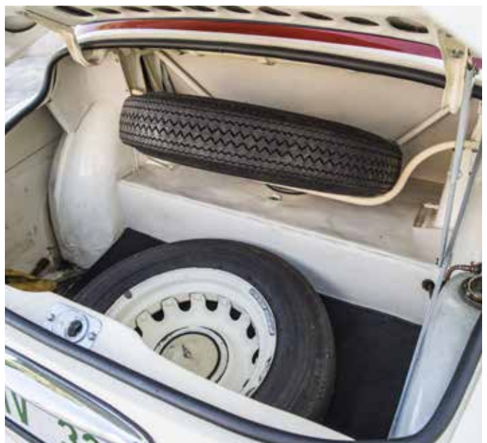
Für alle Fälle: zwei Ersatzräder und Raum für Werkzeug im Ladeabteil des Rallye-Spartak.
