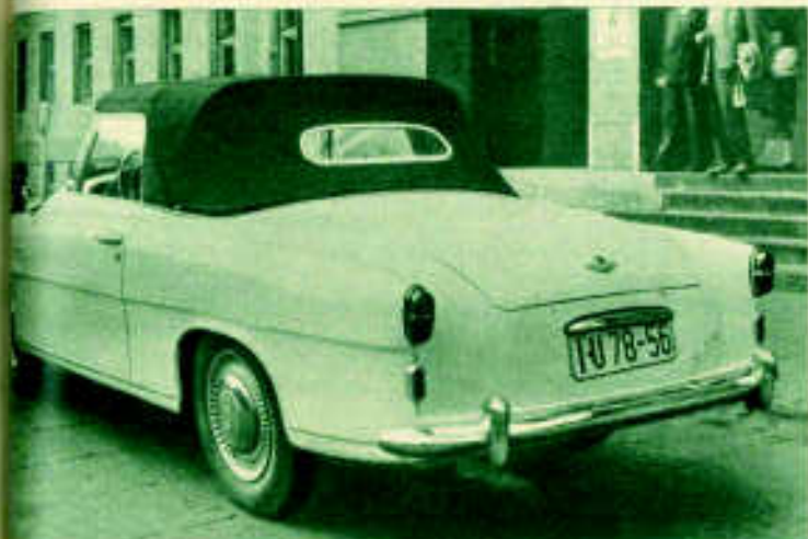
Das Klopferdeck wird, wie im Bild sichtbar, durch zwei Springel abgestützt und vom am Rahmen der Windschutzscheibe mit zwei Schnellverschlüssen gehalten.
