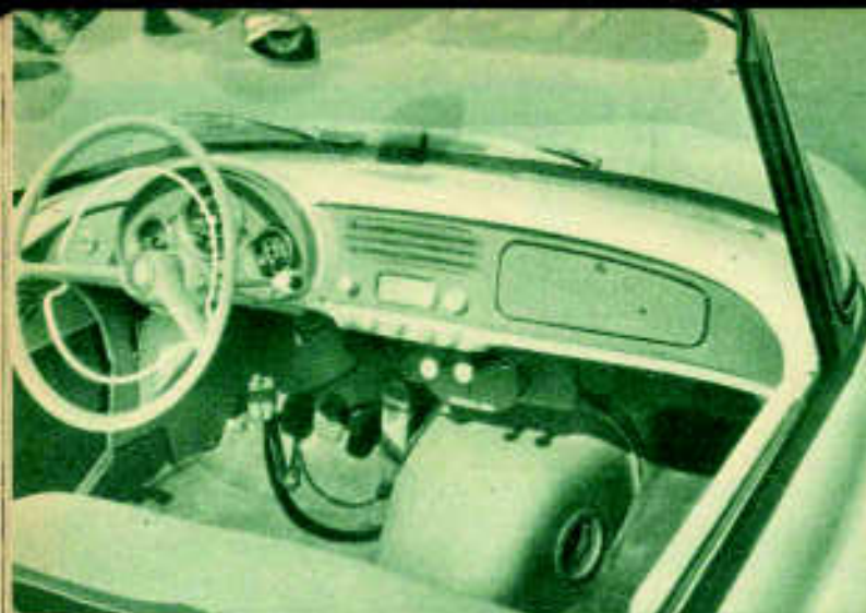
In der Mitte des Armaturenbrettes ist Platz für einen Lautsprecher. Das Bedienungsteil eines Bordradio muß man allerdings anderweitig unterbringen. Unter der Lautsprecherabblendung befinden sich links der Lichtschalter und rechts vom Aschenbecher der Regelwiderstand für die Armaturenbekleuchtung. Darunter die Zugknöpfe für Gebläse, Scheibenwischer usw., in der Mitte der Blinkerschalter.
