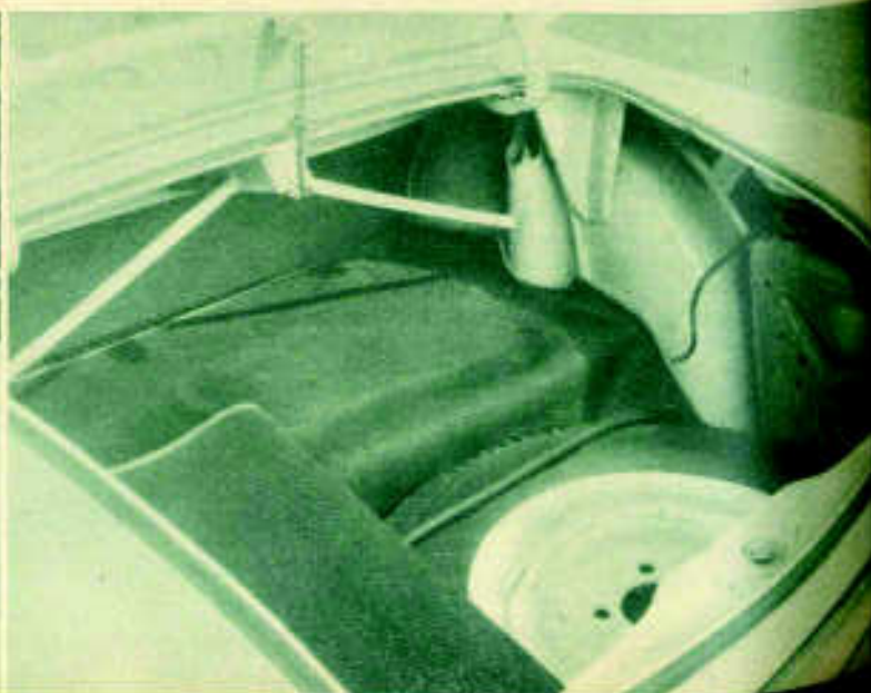
Infolge der Rotheren Gestaltung des Hecks wurde das Reserverad liegend im Kofferraum untergebracht und mit einer Gummimatte abgedeckt. Platz und Anschlaggurt für einen 20-Liter-Kanister sind hinter dem linken Radkasten vorhanden.
