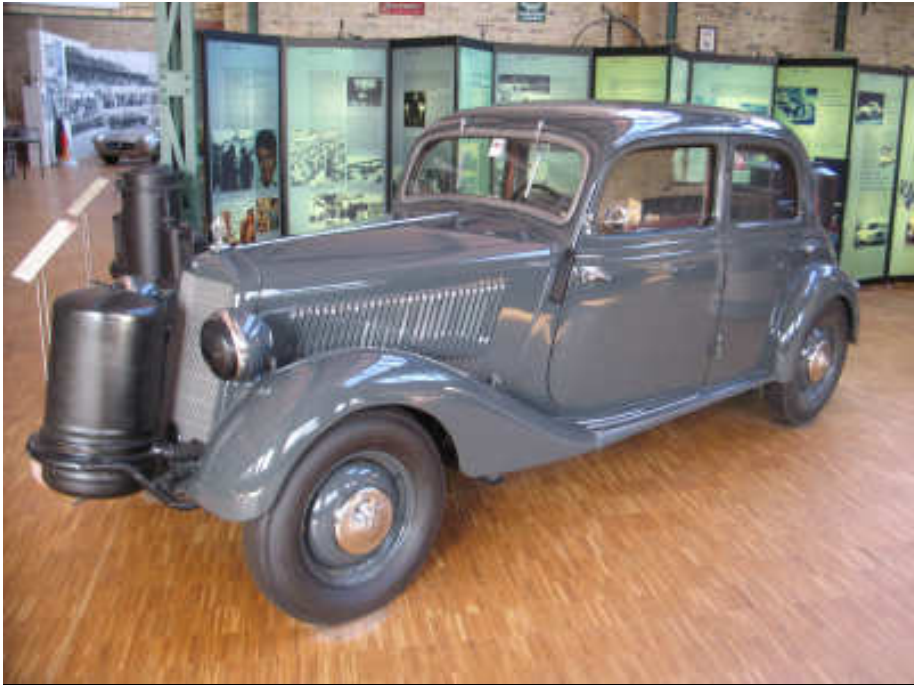
Sparmodell, 170 VGW, 1939-43 mit Holzvergaser, 22 PS und ein Heck-Merc.H, 1937
