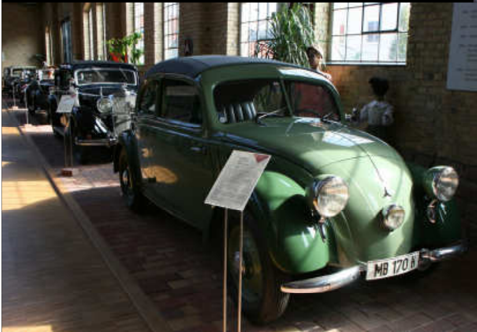
Sparmodell, 170 VGW, 1939-43 mit Holzvergaser, 22 PS und ein Heck-Merc.H, 1937
