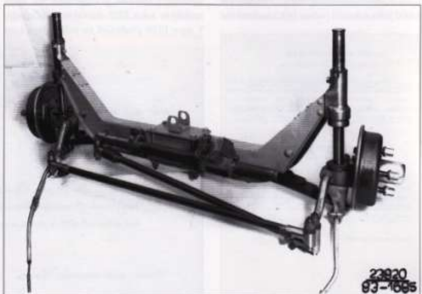
Přední náprava Škoda 222. Obdobnou konstrukci přední nápravy používal v 80. letech mistr Evropy v autokrosu Willi Rösler
