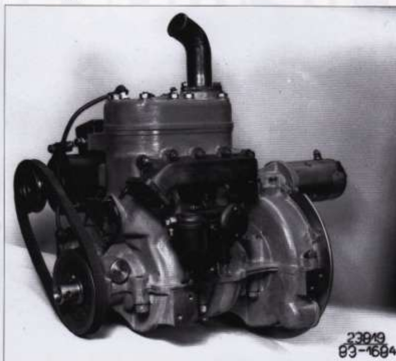
Dvoudobý dvouválcový motor s rozvodem šoupátkem o objemu 750 ccm
