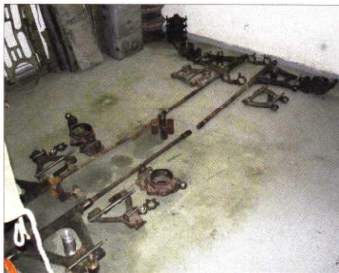
Kompletace částí dílů přední a zadní nápravy. Patrné jsou dvojice předních a zadních torzních tyčí, obaly reduktorů, spodní a horní ramena s čepy
