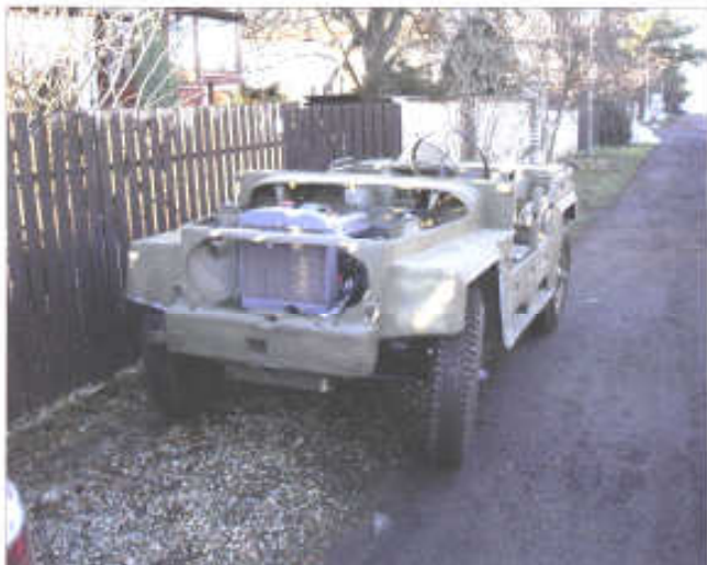
Blíží se finále! Foto po dokončené montáži podvozku a ležícího agregátu do samostatné karosérie, která je po namontování stříkaná kovu připravena k brzdění
