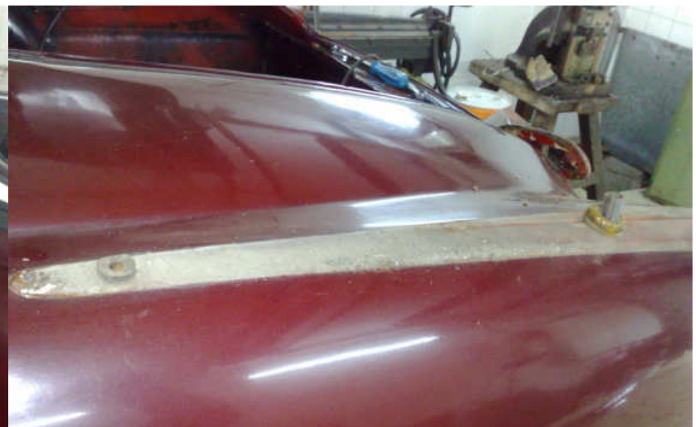
Felicia. Car.Nr: 12 134 Auf dem Bild (unten) erkennt man die originale Abdichtung und die Abstandshülse der Heckflosse.
