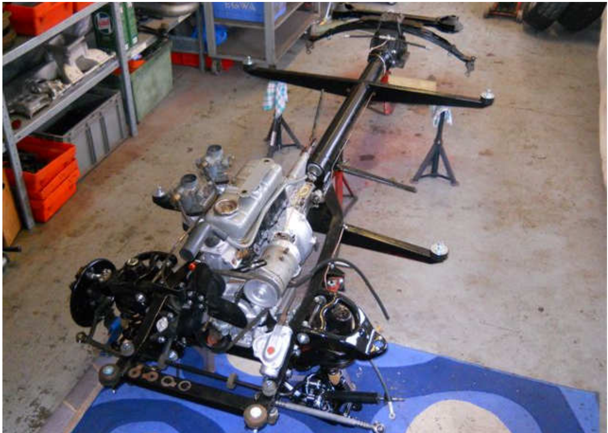
Fahrgestell Motor, Kupplung, Getriebe und Kardanwelle, Lenkung Bremsanlage erneuert
